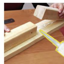
**MULTIFISS LEGNO** è una colla monocomponente strutturale di alta qualità per costruzioni in legno, con un'alta forza adesiva, impermeabile e con grandi prestazioni meccaniche, grazie ad una nuovissima tecnologia di polimeri (norma D4 in attesa di rilascio) che conferisce alla colla alte prestazioni e la rendono più resistente del legno.
